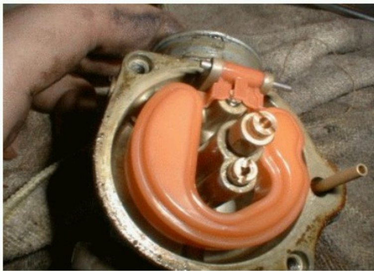
Blick in die Schwimmerkammer eines Mehrdüsenvergasers
