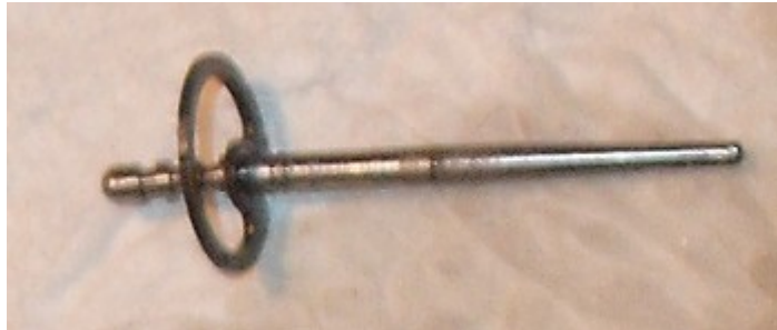
Schiebernadel in ausgebautem Zustand (hier mit beschädigter Spitze!)
