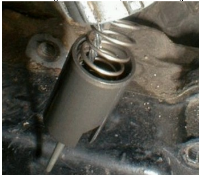
Schieber komplett mit Rückstellfeder und Nadel
