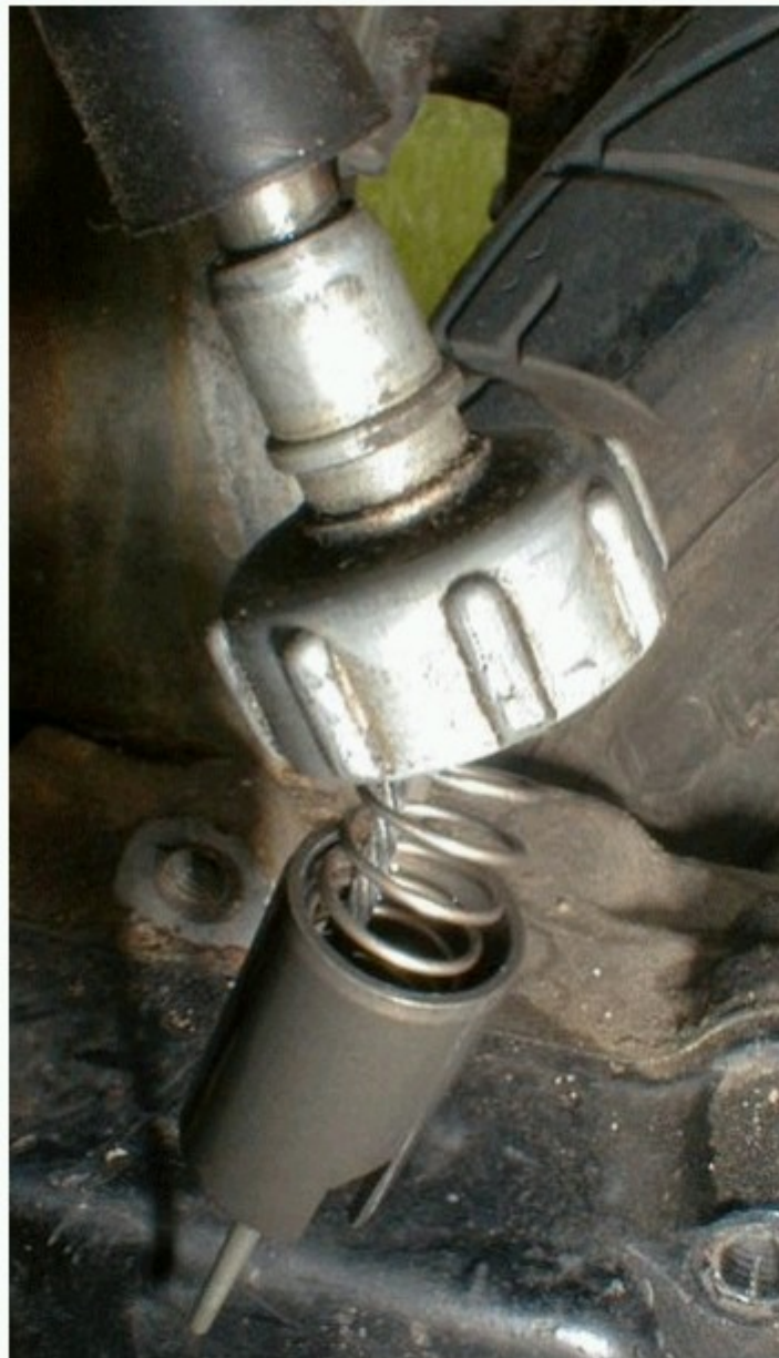
die gelöste Vergaserkrone mit Schieber, Rückstellfeder und Gaszug
