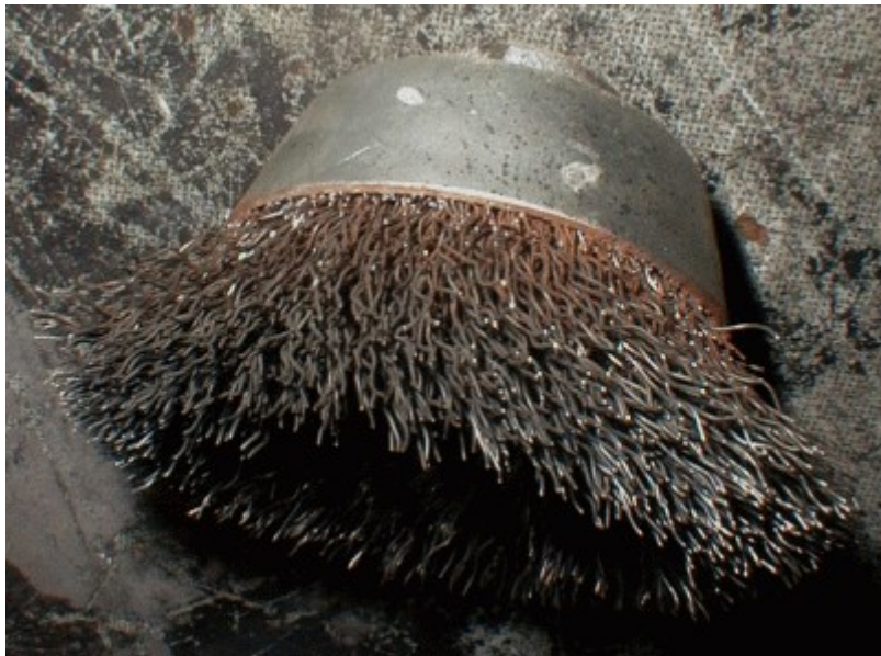
verschiedene Drahtbürstenaufsätze für Bohrmaschine und Winkelschleifer
