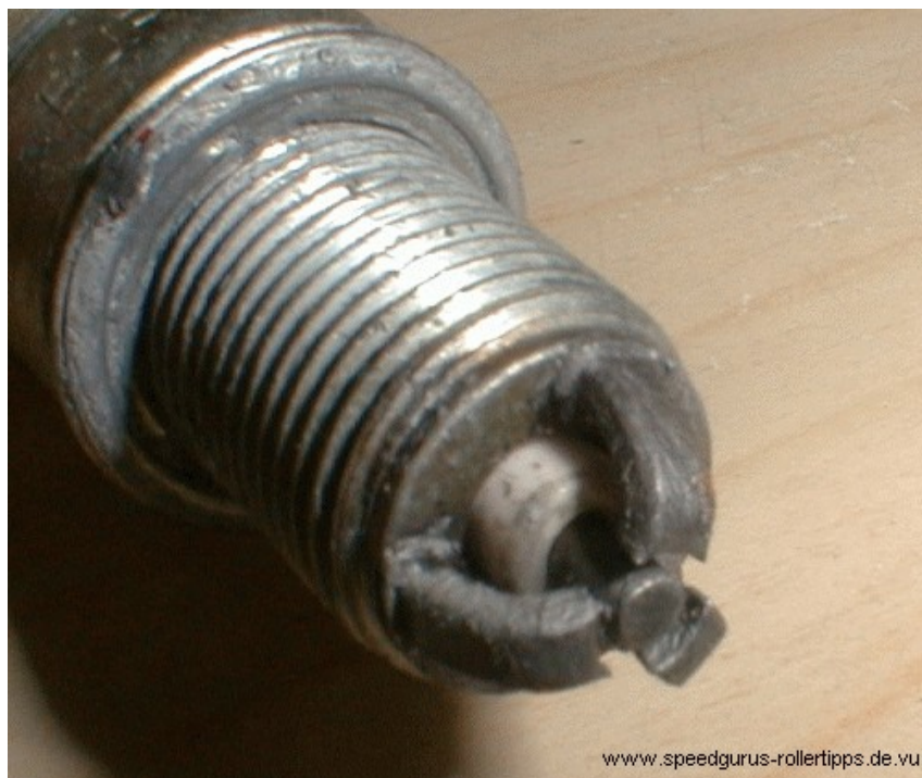
Zündkerze mit drei Masseelektroden
