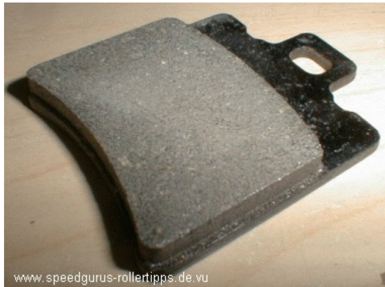
Bremsbelag wie er bei den meisten Rollern mit Scheibenbremse eingesetzt wird.
