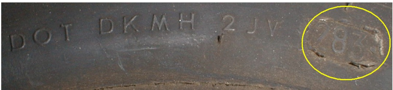
DOT Nummer auf einem Reifen aus den 1980er Jahren. Die Nummer 283 besagt das der Reifen in der 28. Kalenderwoche 1983 hergestellt wurde.
