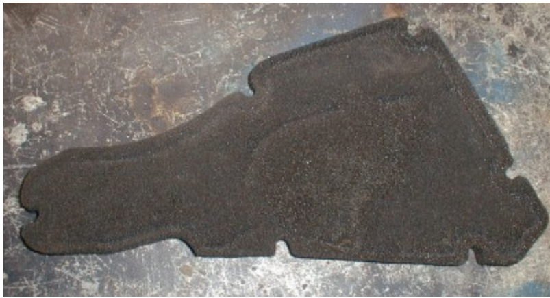
der eigentliche Luftfilter
