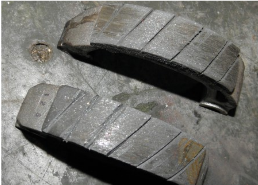
Abbildung 2: Beläge nach dem Schlitzten und brechen der Kanten
