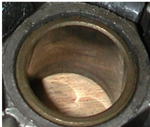
intakte Herzlochbuchse (Bild von Benjamin Schmitz)
