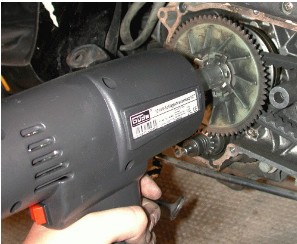
Lösen der Mutter mit einem Schlagschrauber, im Bild ein Piaggiomotor der ersten Generation (Bild von Benjamin Schmitz)
