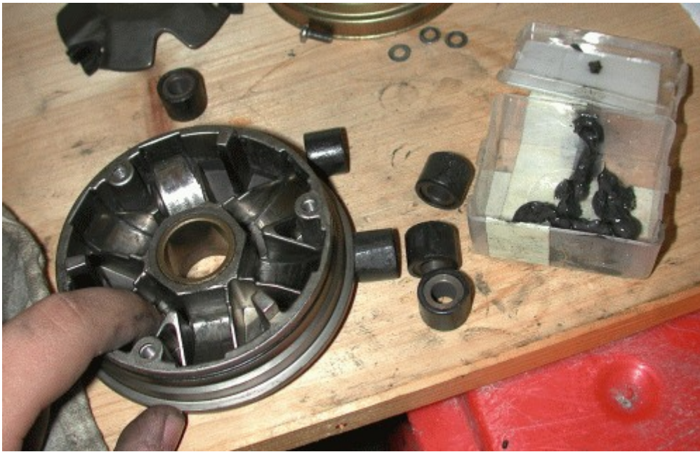
Beim Zusammenbau nicht am Fett sparen! (Bild von Benjamin Schmitz)
