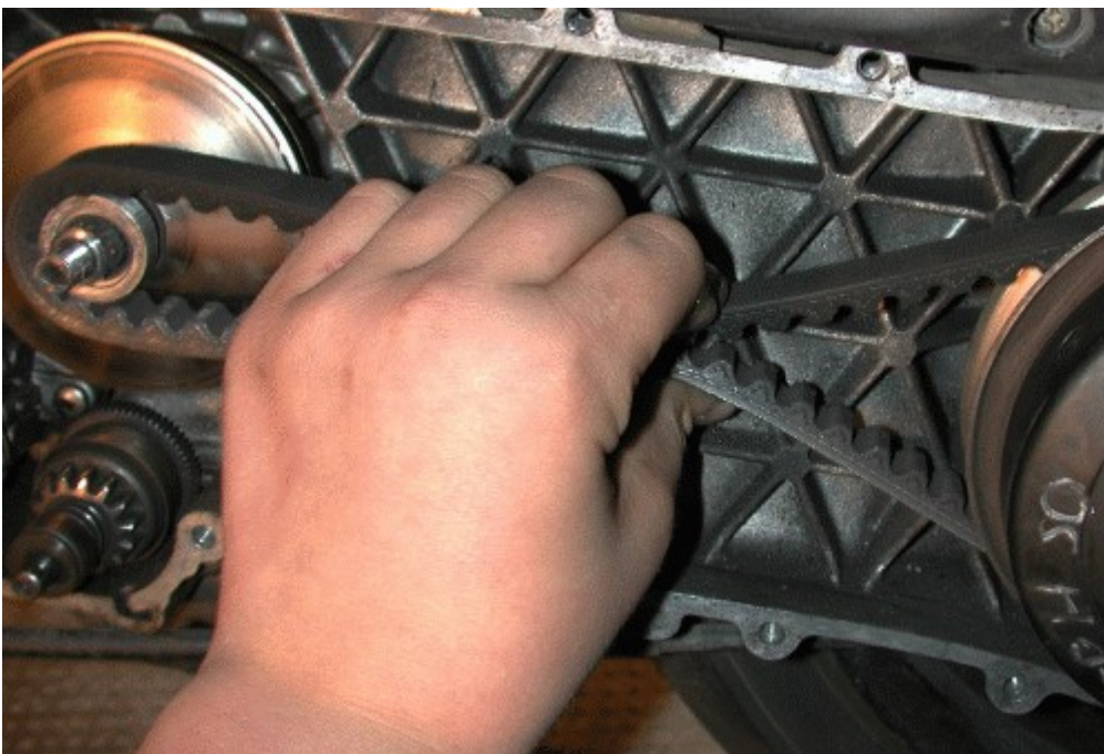
Zum leichteren Abziehen den Riemen in der Mitte etwas zusammendrücken. (Bild von Benjamin Schmitz)
