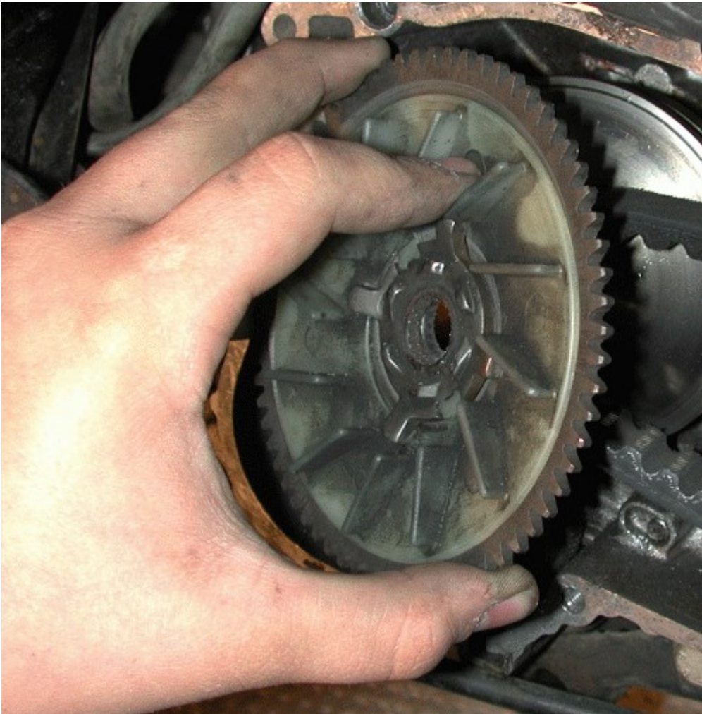
Abnehmen der Riemenscheibe (Bild von Benjamin Schmitz)
