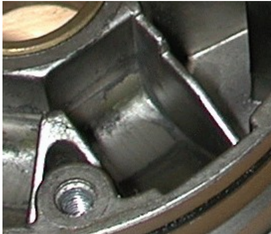
Gut "eingelaufene" Laufbahn eines viel gelaufenen aber immer noch intakten Variators (Bild von Benjamin Schmitz)
