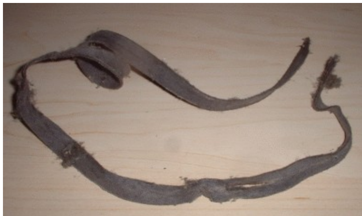
überalterter und abgerissener Treibriemen von dem sich die komplette Gummibeschichtung abgelöst hat solche extremen Riemenschäden treten nur selten auf haben jedoch meist verheerende Begleiterscheinungen
