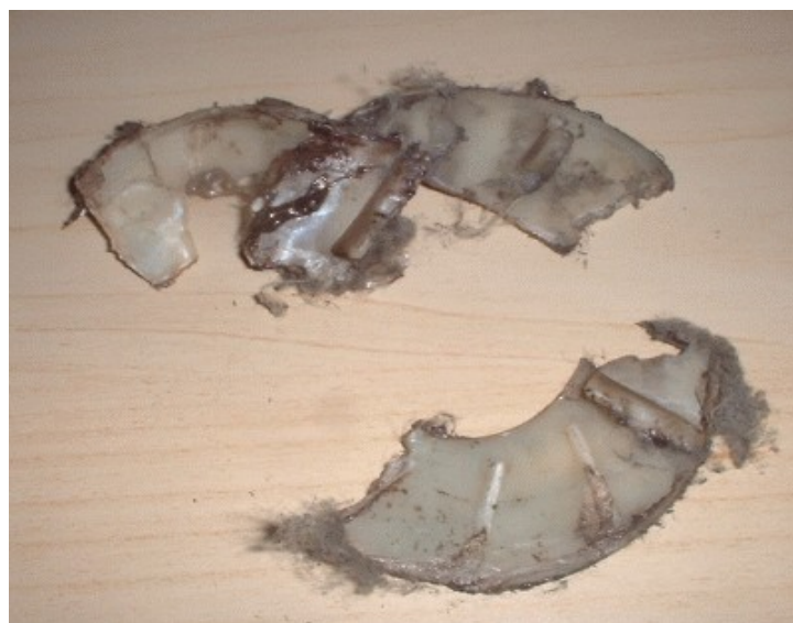
vor herum fliegenden Riemenresten zerstörtes Lüfterrad
