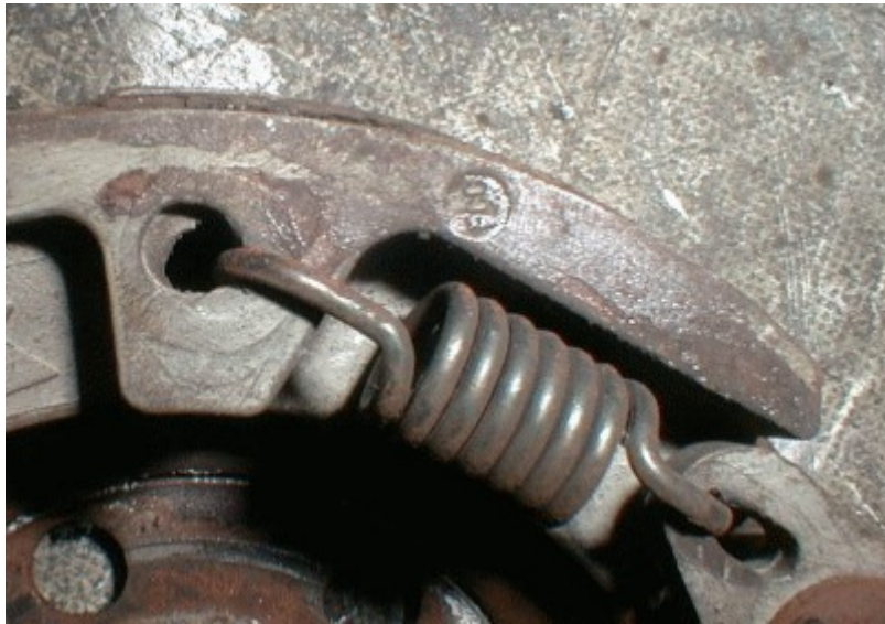
völlig verschlissener Kupplungsbelag
