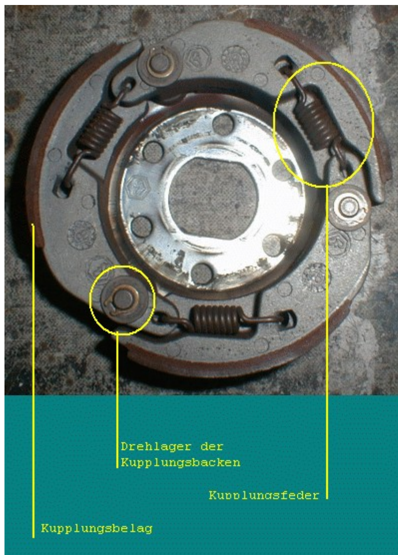
Bauteile der Fliehkraftkupplung
