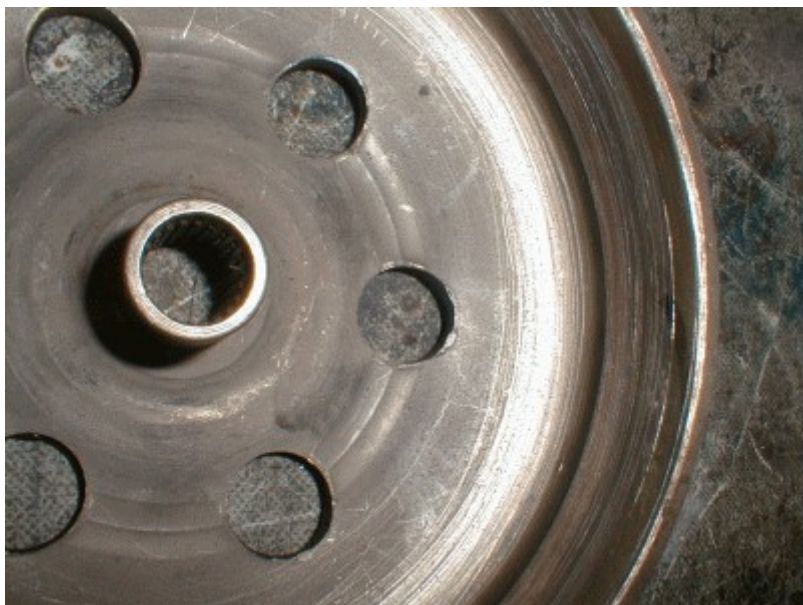
Die Kupplungsglocke nach dem Ausschleifen. Die zerkratzten, riefigen Laufflächen sind gewollt. Hier sorgen die "Schrammen" für verbesserten Griff.
