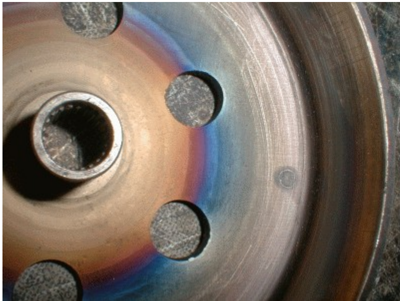
Typische, blaue Ausglühspuren und bräunliche Verglasungen einer gebrauchten Kupplungsglocke.
